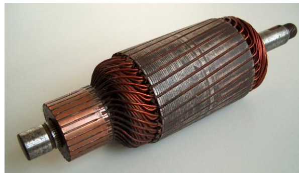
Figura 11.4. Rotor da máquina DC com coletor, enrolamentos do induzido e núcleo do induzido.
