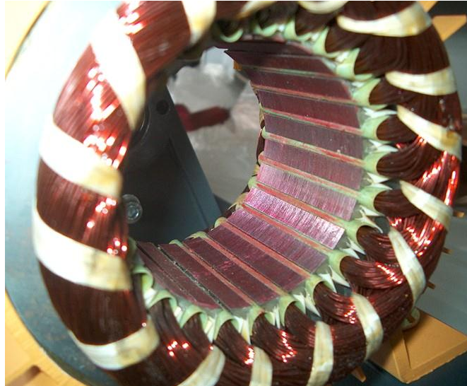
Figura 9.2. Constituição do enrolamento do estator.
