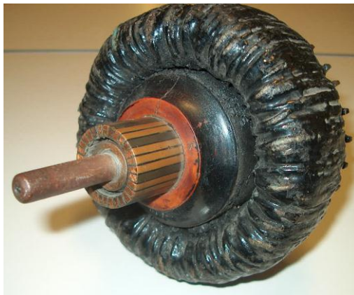
Figura 11.5. Enrolamento em anel.
